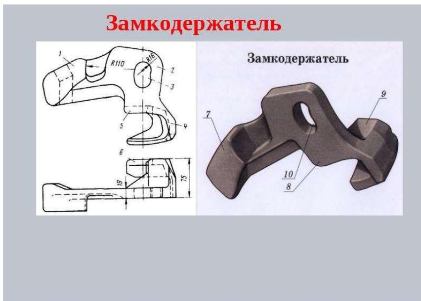
Замкодержатель — это деталь, которая является составным элементом конструкции автосцепного устройства СА-3. Данный элемент выполняет функцию удержания замка в нижнем положении при соединенном состоянии автосцепок. В случае если автосцепки расцеплены, то до разведения вагонов замкодержатель вместе с подъемником выполняет функцию фиксации замка в верхнем положении.
