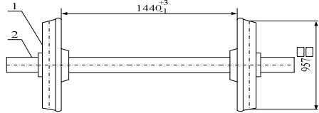
1. Определить допуск для номинального размера 1440
