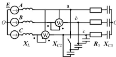
Вследствие аварии произошло замыкание накоротко одного из сопротивлений или разрыв в цепи (место разрыва на схемах указано соответствующим рубильником) и вновь возникшая цепь приемника электрической энергии стала несимметричной.
