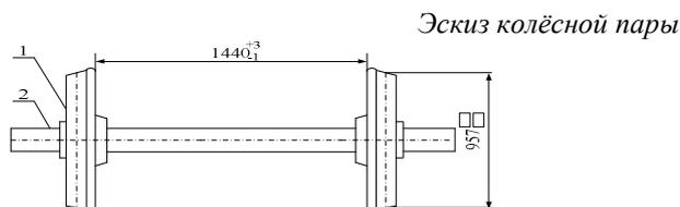
1. Определить допуск для номинального размера 1440
