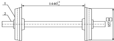
1. Определить допуск для номинального размера 1440
