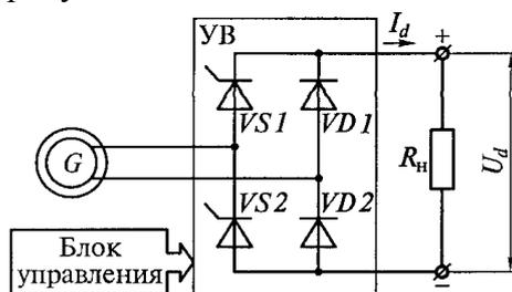
А) однофазного управляемого однополупериодного выпрямителя
