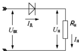
А) однофазного однополупериодного выпрямителя (+)
