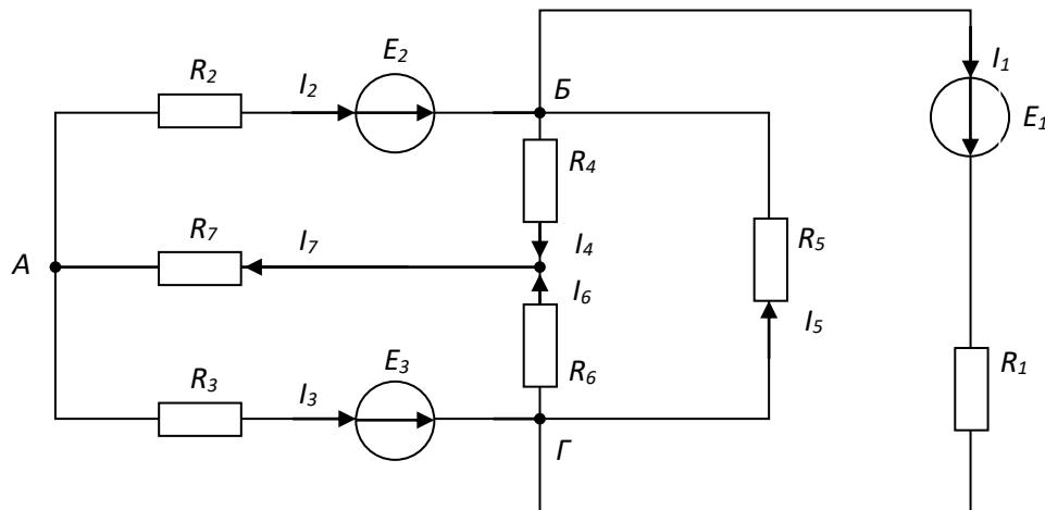
а)  $I_4 R_4 - I_6 R_6 + I_5 R_5 = E_1$
