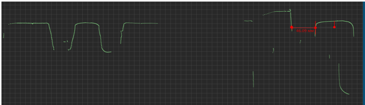
Рисунок 10 – Пример 2D-сечения 40 мм сердечника крестовины стрелочного перевода
