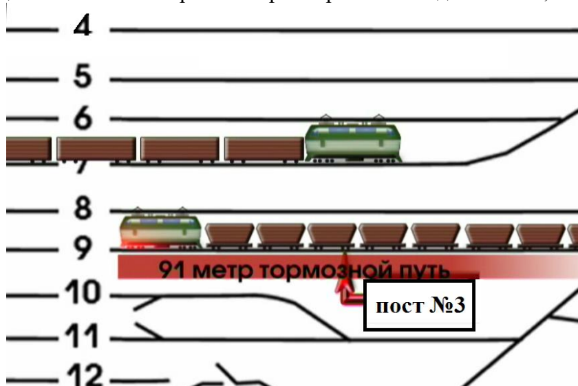
Рис.4 Схема происшествия по травмированию сигналиста Виноградовой А.П.
