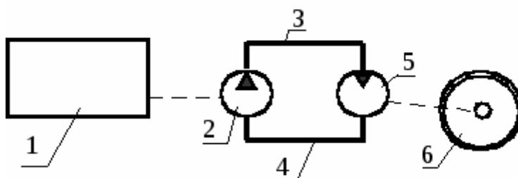
случае состоит из приводимого в двигателем 1, и вращающего колеса соединены напорным 4 трубопроводами, по циркулирует рабочая
