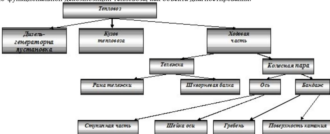
Рис 1 Блочно—функциональная декомпозиция
