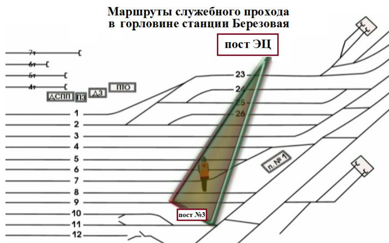
Рис.3 Визуальный контроль во время работы маневрового диспетчера
