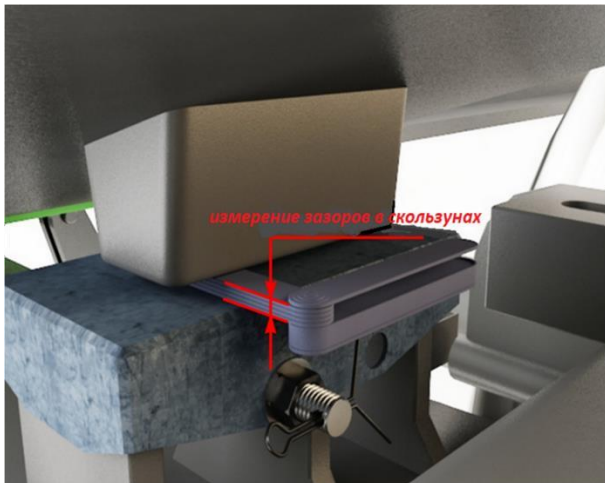
Измерение зазора между скользунами
