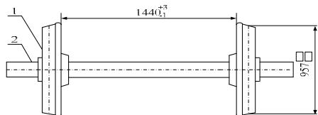
1. Определить допуск для номинального размера 1440
