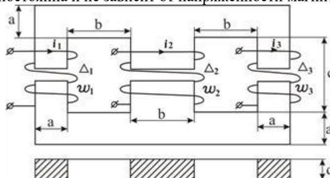
Геометрические размеры магнитопровода указаны на рисунке. Конкретный расчётный вариант, выбирается в соответствие с буквенной литерой. Конструкция включает две обмотки, по одной из которых протекает электрический ток. Один из трёх стержней магнитопровода имеет воздушный зазор. Для всех вариантов величина тока определяется по формуле:  $i = 1 + 0,1 (n/m) \text{ A}$ .
